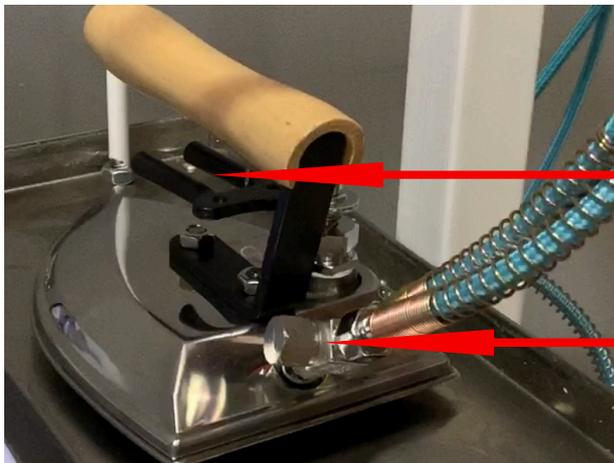
**Palanca de accionamiento de vapor**
